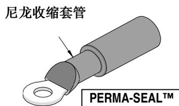
绝缘套管。它有一个漏斗入口，避免穿入电线时芯线被折回。Molex提供的型号可连接10至22 AWG（0.10至6.60平方毫米）电线。
